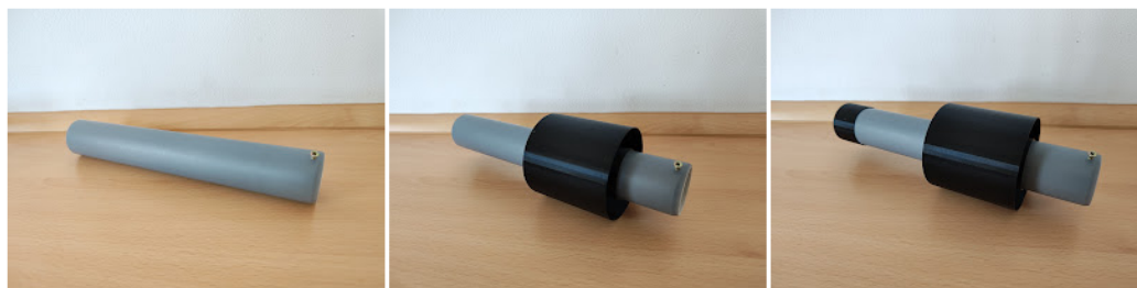
Obrázek 9: Sestavení okulárového výťahu. Na jednu stranu přivrtáme jistící vrut, který zabráni vypadnutí okulárového výťahu z dalekohledu. Nasadíme držák trubky okuláru a nakonec držák samotného okuláru.
