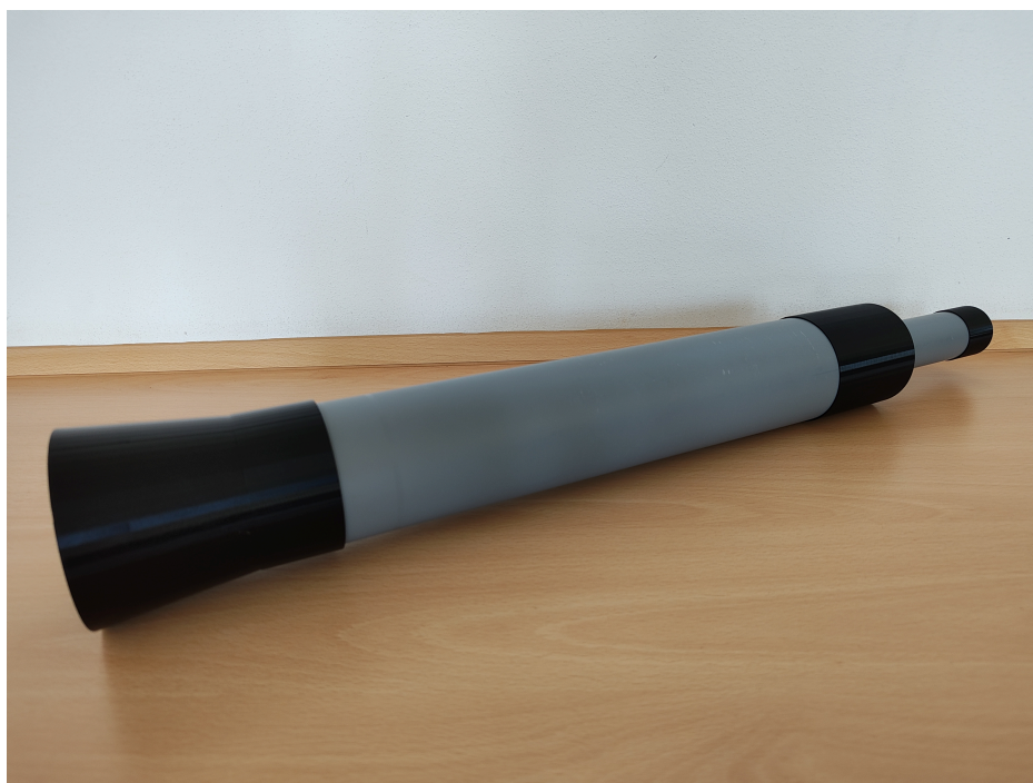
Obrázek 5: Zkušební sestavení hlavního tubusu a okulárové trubky.
