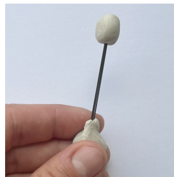
(c) Dvojštěrbina z tuh do mikrotužky a plastelíny.
