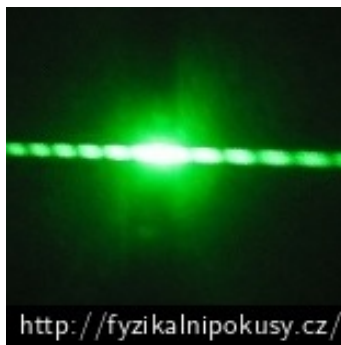
(b) Interferenční obrazec na zdi vytvořený pomocí laserového ukazovátka a dvojštěrbiny [8].
