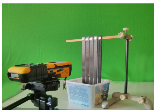
Obrázek č. 12 – uspořádání pokusu na tepelnou vodivost látek
