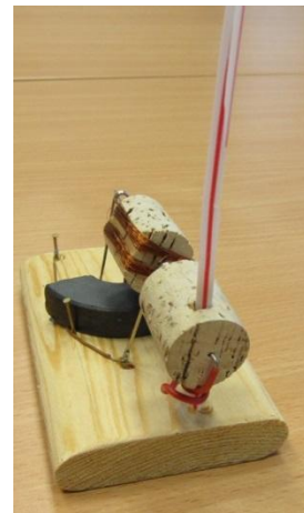
Obr. 2. Model měřicího přístroje s otočnou cívkou
